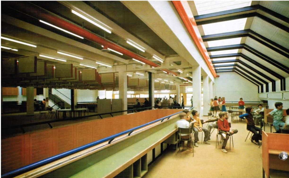
Abbildung 10: Die ‚Teppichaula‘ im 1.OG des Zentraltraktes mit Oberlichten in der Raumfuge zwischen den Trakten <sup>80</sup>
